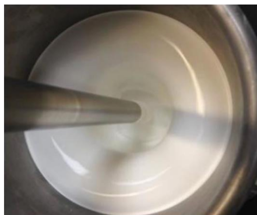
Fig. 2 - Fluxo laminar durante a dispersão
